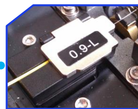
Wymienne uchwyty: dla włókien pigtailowych 0,9mm z luźną tubą dla patchcordów z powłokami 2,5-3,0mm dla kabli wewnątrzbudynkowych (FTTX płaskie) dla złączy dospawywanych Splice-On Connector (SOC)
